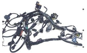
Moderne Fahrzeuge haben rund 700 Steckverbinder für fast 3000 Kabel, die wichtige Informationen zwischen Modulen übertragen (https://blogs.sw.siemens.com/ee-systems/2020/07/28/wiring-harness-development-intodays-automotive-world/)
